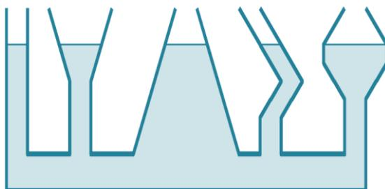
Fig. de gauche : "principe" des *vases communicants*.
